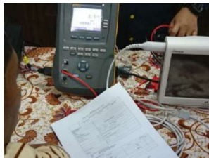
Gambar 4. Pengukuran nilai grounding pada RSUD Tugu Koja
